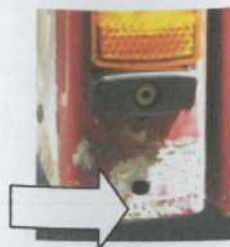
Obr. č. 11. Pravý zadní sloupek značná korozie
